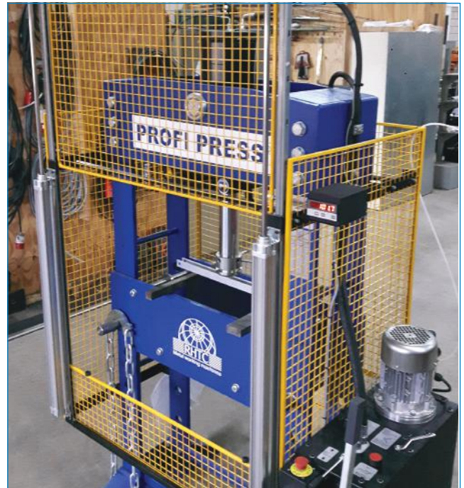
🇬🇧 Press with protection fence. 🇩🇪 Presse mit Schutzzaun.
