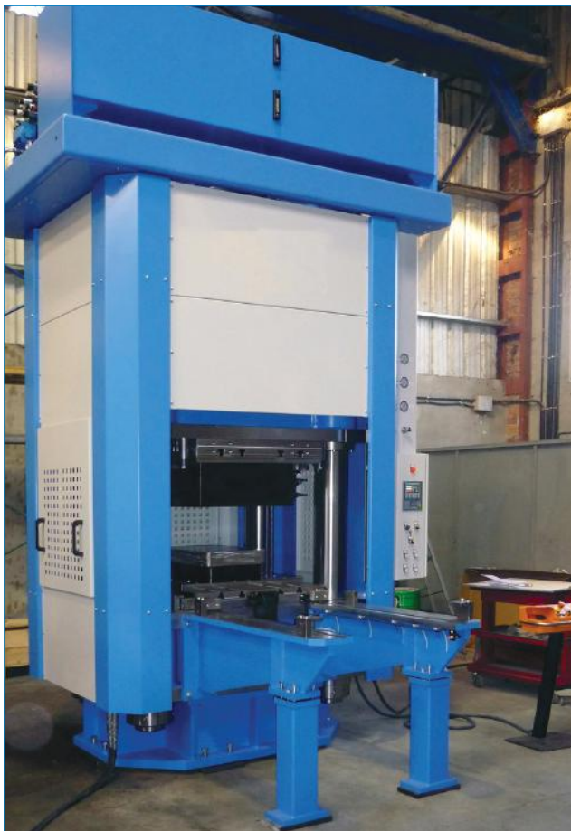
🇬🇧 Special four column press with NC-control. 🇩🇪 Spezielle Vier-Säulen Presse mit NC-Steuerung
