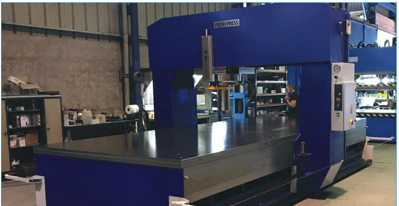
🇬🇧 Portal press (400 ton) with 6 meter table length. 🇩🇪 Portalpresses (400 Tonnen) mit 6 Meter Tischlänge.
