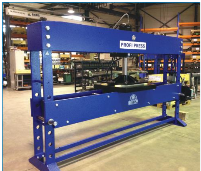
🇬🇧 Workshop press with 3.000 mm working width. 🇩🇪 Werkstattpresse mit 3.000 mm Arbeitsbreite.
