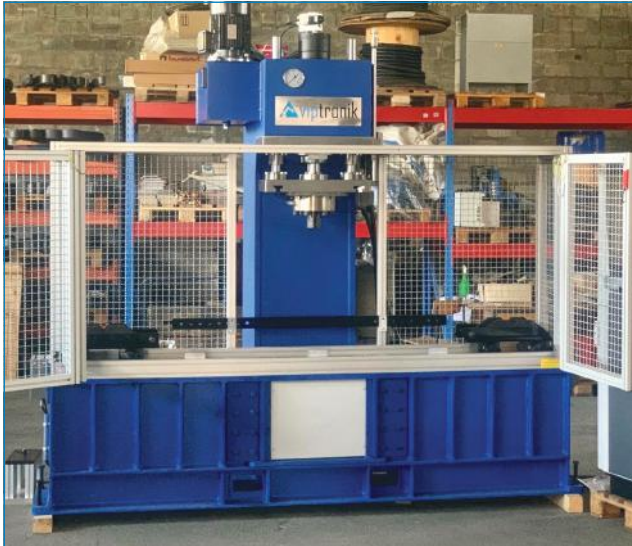
🇬🇧 C-frame press as spring testing machine. 🇩🇪 C-Rahmenpresse als Federprüfmaschine.
