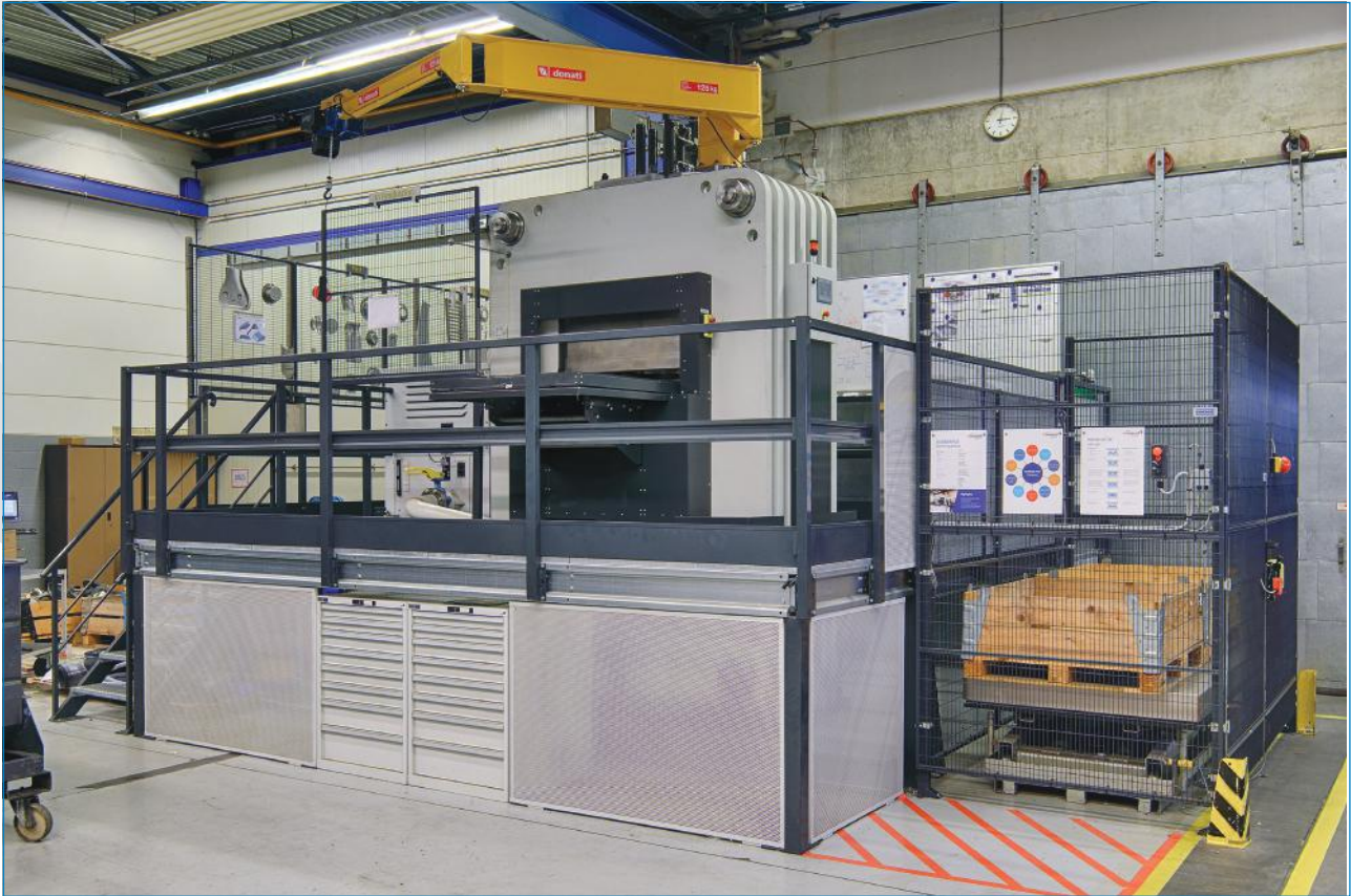
RUBBERPAD FORMING PRESS (2000 TON) / GUMMIKISSEN-PRESSE (2000 TONNEN)
