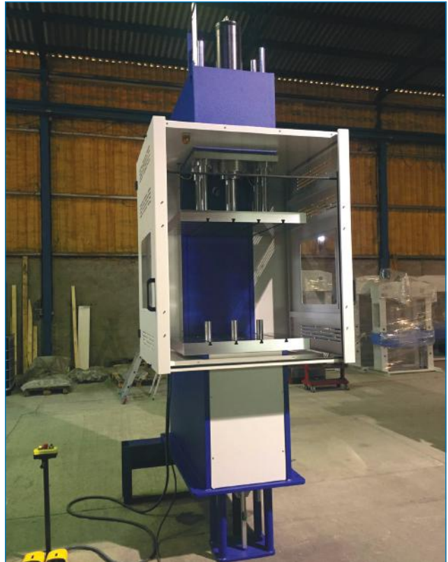
🇬🇧 C-frame press with ejectors and larger vertical light & piston stroke. 🇩🇪 C-Rahmenpresse mit Auswerfer und ein größerer lichte Höhe & Kolbenhub.
